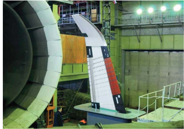
ΔΟΚΙΜΕΣ ΣΕ ΑΕΡΟΣΥΡΑΡΤΑ ΤΜΗΜΑΤΟΣ ΠΤΕΡΥΓΑΣ ΑΕΡΟΣΚΑΦΟΥΣ ΑΠΟ ΣΥΝΘΕΤΑ ΥΛΙΚΑ (ΕΥΡΩΠΑΪΚΟ ΠΡΟΓΡΑΜΜΑ SARISTU) WIND TUNNEL TESTING OF AIRCRAFT WING SECTION USING COMPOSITE MATERIALS (SARISTU PROJECT)
