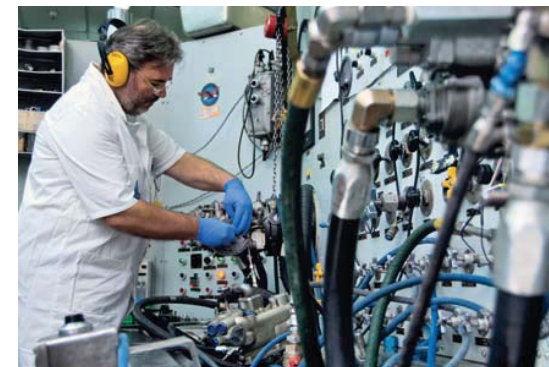
ΔΟΚΙΜΗ ΠΑΡΕΛΚΟΜΕΝΟΥ ΑΕΡΟΚΙΝΗΤΗΡΑ ENGINE ACCESSORIES TEST STAND
