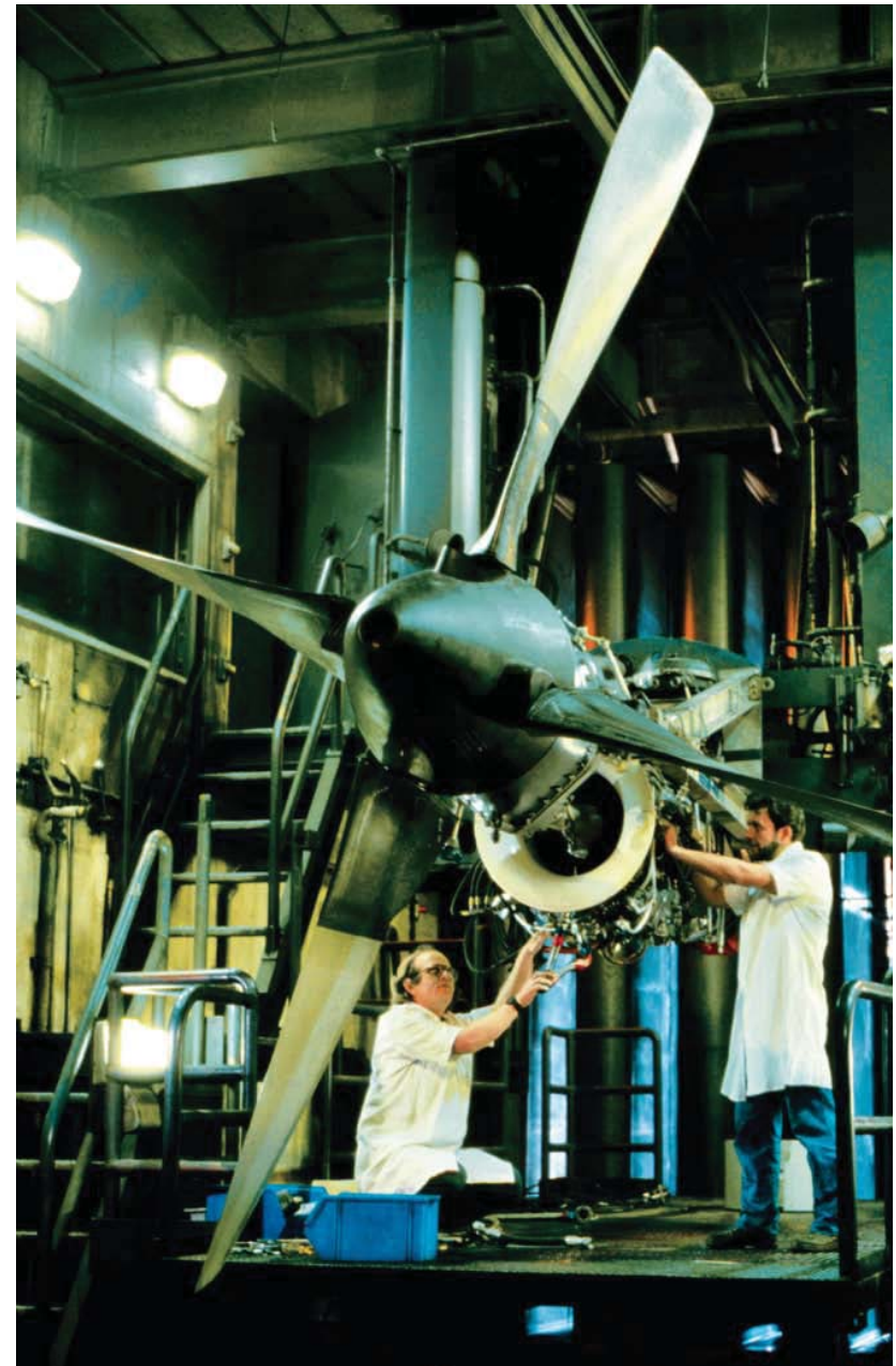
ΠΡΟΕΤΟΙΜΑΣΙΑ ΓΙΑ ΔΟΚΙΜΗ ΕΝΟΣ ΚΙΝΗΤΗΡΑ T56 T56 ENGINE IN PREPARATION FOR TEST
