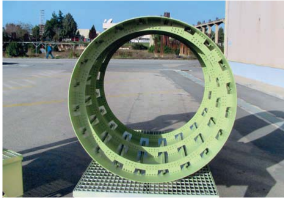
ΤΜΗΜΑ ΥΠΟ ΚΛΙΜΑΚΑ ΜΕΤΑΛΛΙΚΗΣ ΑΤΡΑΚΤΟΥ Α/Φ (ΕΥΡΩΠΑΪΚΟ ΠΡΟΓΡΑΜΜΑ VULCAN) SCALED SECTION OF METALLIC AIRCRAFT FUSELAGE STRUCTURE (EU FUNDED PROGRAM - VULCAN)
