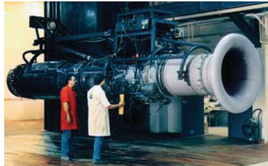
ΕΠΙΣΤΑΣΙΑΚΗ ΣΥΝΤΗΡΗΣΗ ΚΙΝΗΤΗΡΑ J79 J79 ENGINE DEPOT MAINTENANCE
