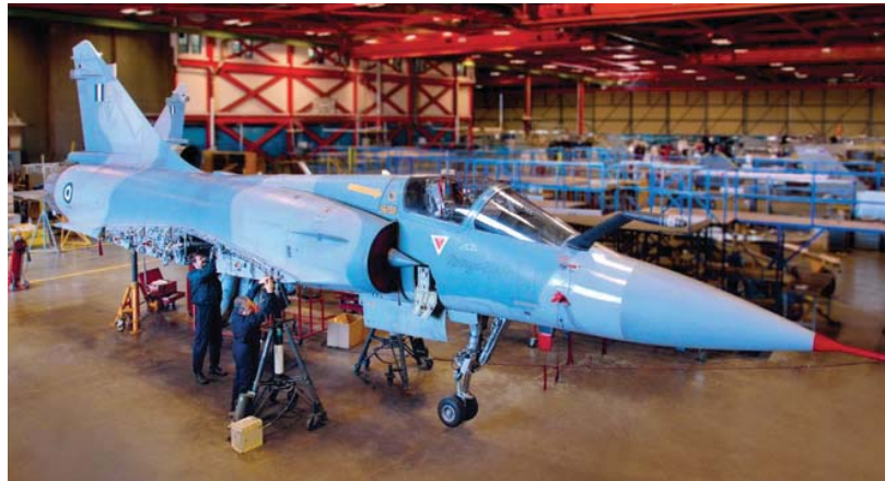
M-2000-5 ΚΑΤΑ ΤΗ ΦΑΣΗ ΕΡΓΟΣΤΑΣΙΑΚΗΣ ΣΥΝΤΗΡΗΣΗΣ M-2000-5 DEPOT MAINTENANCE
