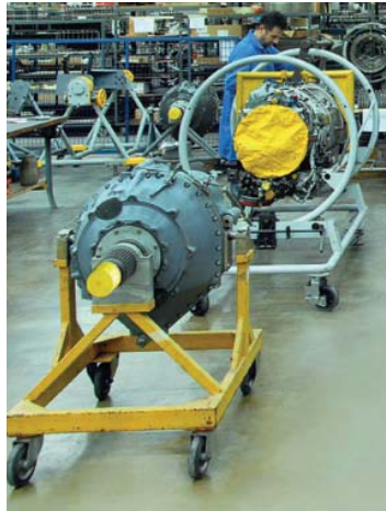
ΑΡΤΙΟ ΚΙΝΗΤΗΡΑ F-110 ΥΦΙΣΤΑΜΕΝΟ ΜΗ ΚΑΤΑΣΤΡΟΦΙΚΟ ΕΛΕΓΧΟ F-110 PART UNDERGOING NDI
