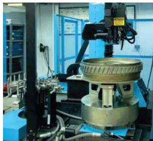
ΑΡΤΙΟ ΚΙΝΗΤΗΡΑ F-110 ΥΦΙΣΤΑΜΕΝΟ ΜΗ ΚΑΤΑΣΤΡΟΦΙΚΟ ΕΛΕΓΧΟ F-110 PART UNDERGOING NDI
