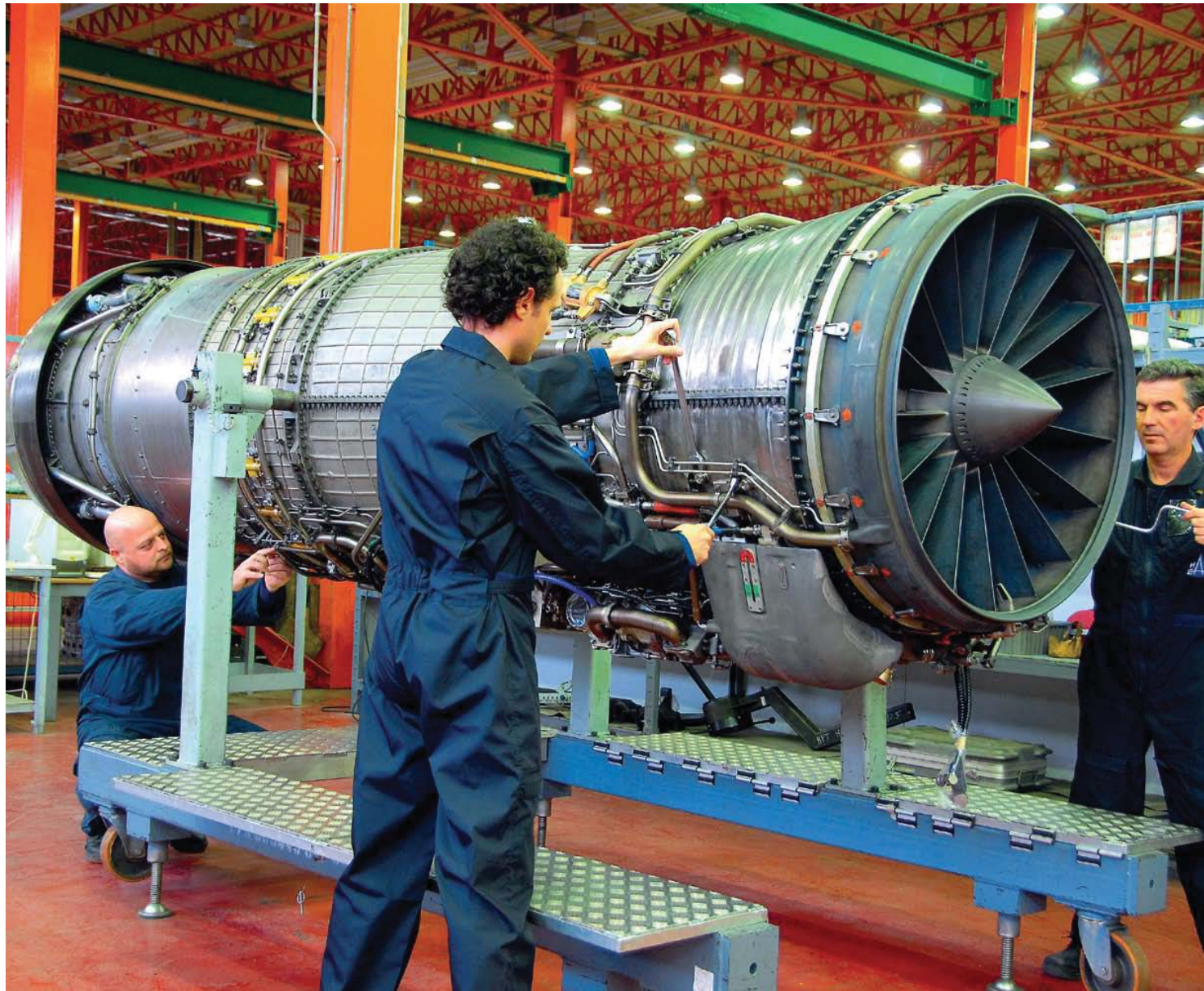
ΕΡΓΟΣΤΑΣΙΑΚΗ ΣΥΝΤΗΡΗΣΗ ΚΙΝΗΤΗΡΑ F110-GE-110C F110-GE-110C ENGINE DEPOT MAINTENANCE
