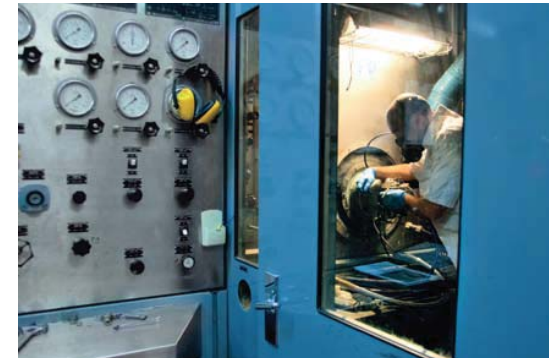
ΔΟΚΙΜΑΣΤΗΡΙΟ ΠΑΡΕΛΚΟΜΕΝΩΝ ΑΕΡΟΚΙΝΗΤΗΡΑ M53 M53 ENGINE, ACCESSORIES TEST STAND
