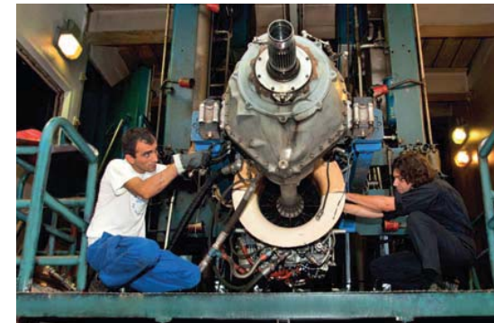
ΠΡΕΤΟΙΜΑΣΙΑ ΔΟΚΙΜΗΣ ΚΙΝΗΤΗΡΑ T-56 T-56 ENGINE IN PREPARATION FOR TEST
