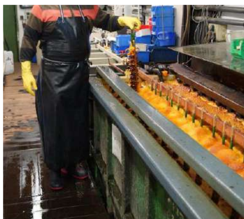
Εικόνα 1: Η φωτογραφία δείχνει επιμετάλλωση σε ανοιχτές δεξαμενές με χειροκίνητη φόρτωση
