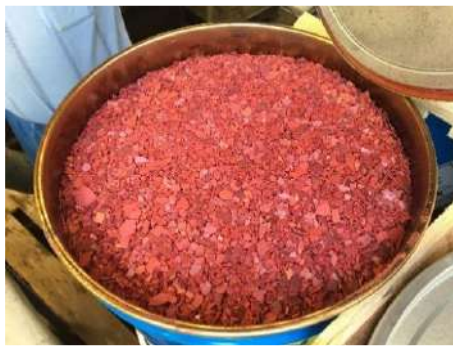
Εικόνα 1: Η φωτογραφία δείχνει ένα ανοιχτό βαρέλι που περιέχει νιφάδες τριοξειδίου του χρωμίου
