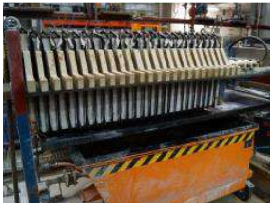
Εικόνα 1: Οι φωτογραφίες δείχνουν τη δεξαμενή συγκράτησης λυμάτων (αριστερά) και πρέσα φίλτρου για αφυδάτωση στερεών σε μονάδα επεξεργασίας λυμάτων (δεξιά)
