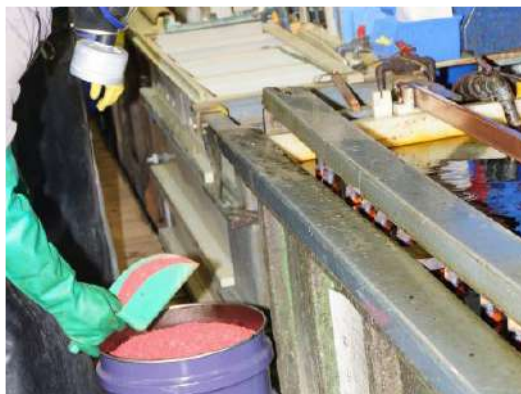
Εικόνα 3: Αυτή η φωτογραφία δείχνει τη διαμόρφωση του λουτρού με τριοξείδιο του χρωμίου
