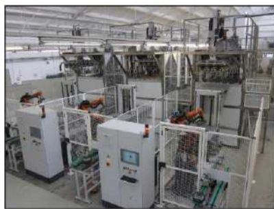
Εικόνα 1: Φωτογραφίες που δείχνουν κλειστά κελιά αντιδραστήρα που χρησιμοποιούνται στην επένδυση ράβδων εμβόλου και βαλβίδων κινητήρα
