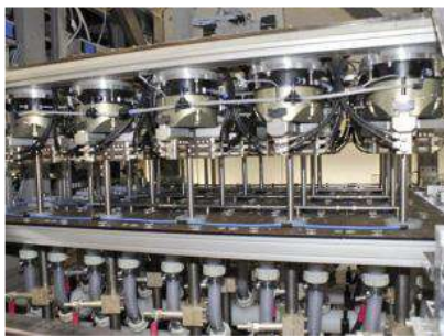
Εικόνα 1: Φωτογραφίες που δείχνουν κλειστά κελιά αντιδραστήρα που χρησιμοποιούνται στην επένδυση ράβδων εμβόλου και βαλβίδων κινητήρα
