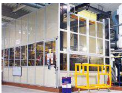
Εικόνα 1: Η φωτογραφία δείχνει θάλαμο που περικλείει συστήματα επιμετάλλωσης και γραμμές ανύψωτήρα
