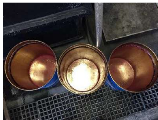
Εικόνα 2: Οι φωτογραφίες δείχνουν (αριστερά) νιφάδες τριοξειδίου του χρωμίου με προσθήκη νερού για τη μείωση της σκόνης κατά την ανάμιξη και (δεξιά) κενά βαρέλια
