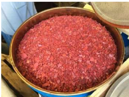
Εικόνα 1: Η φωτογραφία δείχνει ανοιχτά βαρέλια που περιέχουν νιφάδες τριοξειδίου του χρωμίου
