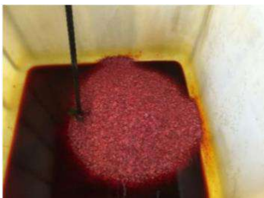
Εικόνα 2: Οι φωτογραφίες δείχνουν (αριστερά) νιφάδες τριοξειδίου του χρωμίου με προσθήκη νερού για τη μείωση της σκόνης κατά την ανάμιξη και (δεξιά) κενά βαρέλια
